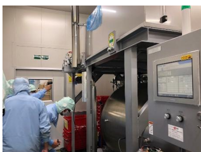
レトルト殺菌機の放熱温度を測定
