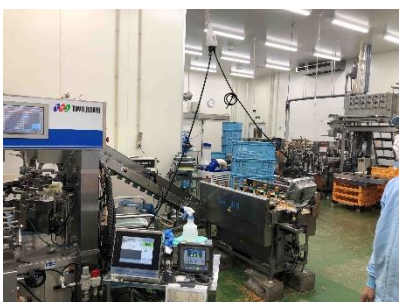
コンプレッサーで稼働する自動計量器
