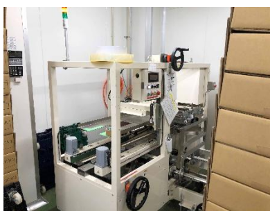
コンプレッサーで稼働する段ボール織機
