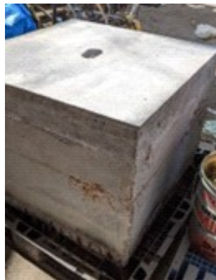
多種類の不燃性産業廃棄物を活用した 路盤材・ブロックの開発
