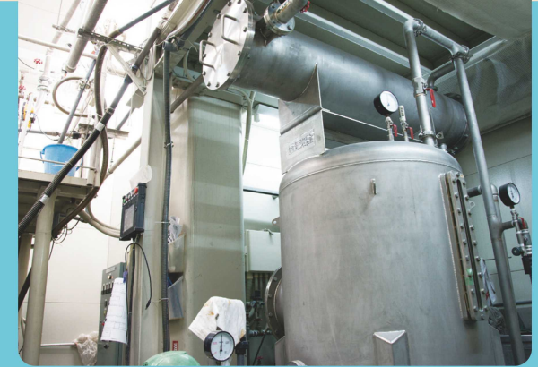
分級作業を行った後、研磨材を乾燥させる装置
