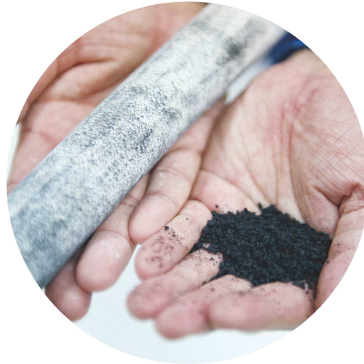
(右) 粉碎したバリゴム (左) 粉碎後に再製品化したゴム
