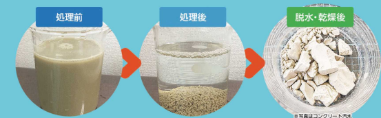
かたるまくんによるコンクリート汚水の処理
