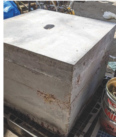
廃石膏ボードと廃ガラスを利用してつくられた多目的コンクリートブロック
