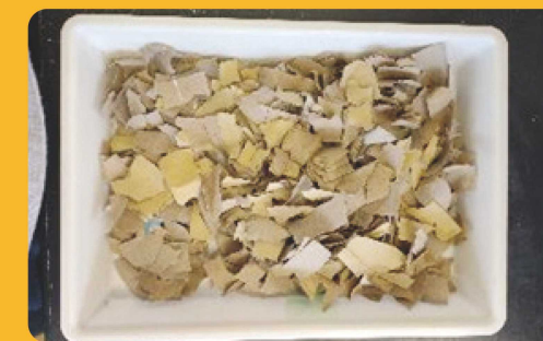
廃石膏ボードから除去された紙片
