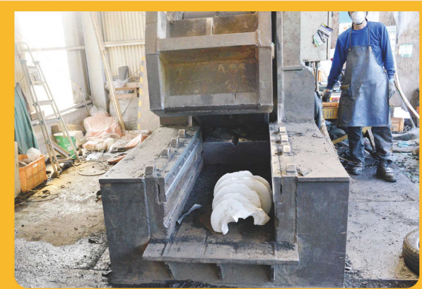
廃ガラスの破碎機
