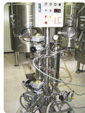
SPG膜ビールろ過装置。SPG膜は、汚れたり、目詰まりしても、焼成することで何度でも新品同様に再生可能です
