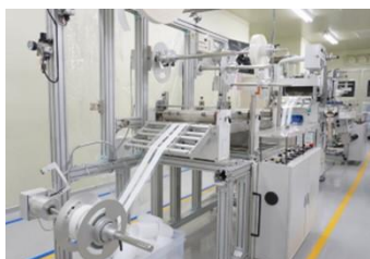
フィルム積層設備
