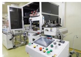
画像位置補正機能付き打ち抜き加工設備
