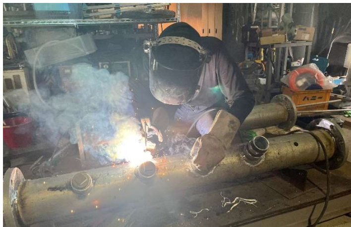
▲蒸気ヘッダー製作
