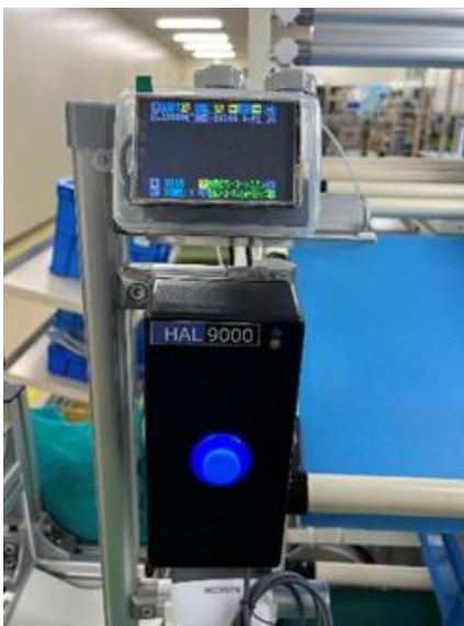
工作機械に取り付けたセンサーとシングルボードコンピュータ(左) デジタルダッシュボードを活用した、実生産時間と標準生産時間の比較可視化テスト(右)
