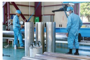
工場でチタン製プラント機器を製作中
