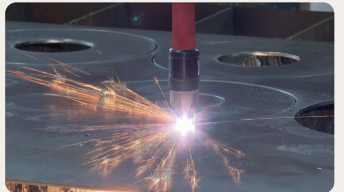
プラズマ切断機による加工
